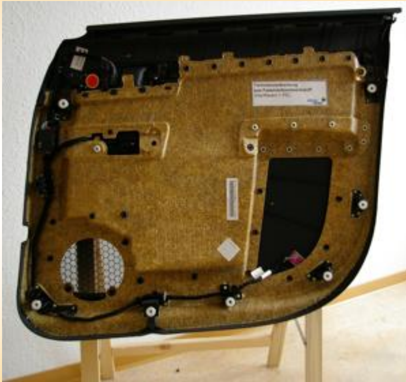
Türinnenverkleidung aus Hanffasern und PE
